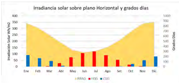
Figura 5: Grados días mensuales de calefacción y refrigeración, en función de la irradiancia solar
