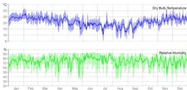
Figura 1: Gráfico da variação anual de temperatura de bulbo seco e umidade relativa em Florianópolis.
