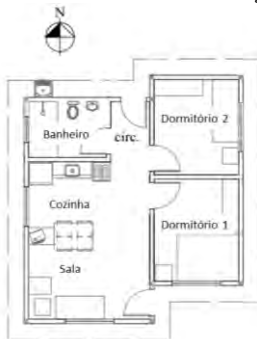
Figura 2: Planta baixa da residência unifamiliar proposta
