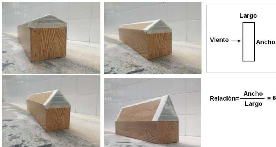
Figura 4: Modelos a escala 1:100 de los edificios ensayados en el Túnel de Viento.
