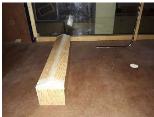
Figura 5: Ubicación del Pitot a sotavento del edificio donde se realizaron las mediciones para el posterior análisis de frecuencias.
